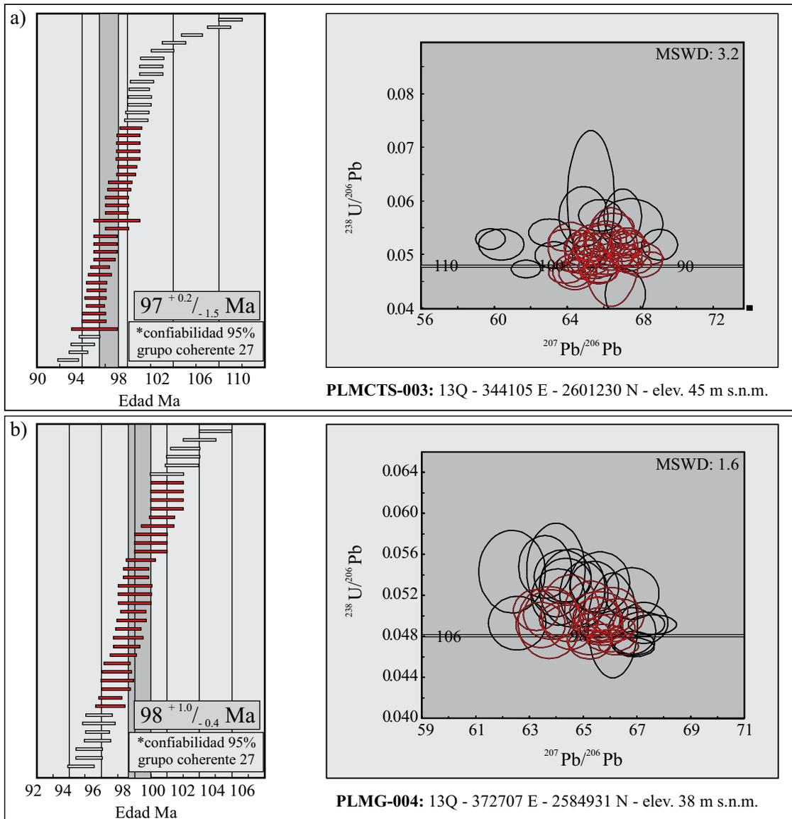
Figura 8. Edades U/Pb en zircon y diagrama de concordia, en rocas muestreadas: a) En el borde y b) En el núcleo de la unidad. MSWD: Mean square of weighted deviates.
