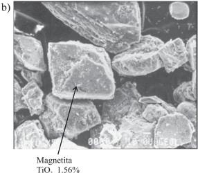
Figura 5. Imágenes de MEB de dos separados magnéticos de las facies de limo rojo (a) y arena (b). Se observan cristales de magnetita casi pura y de Ti-magnetita pobre en Ti, con escasa alteración.
