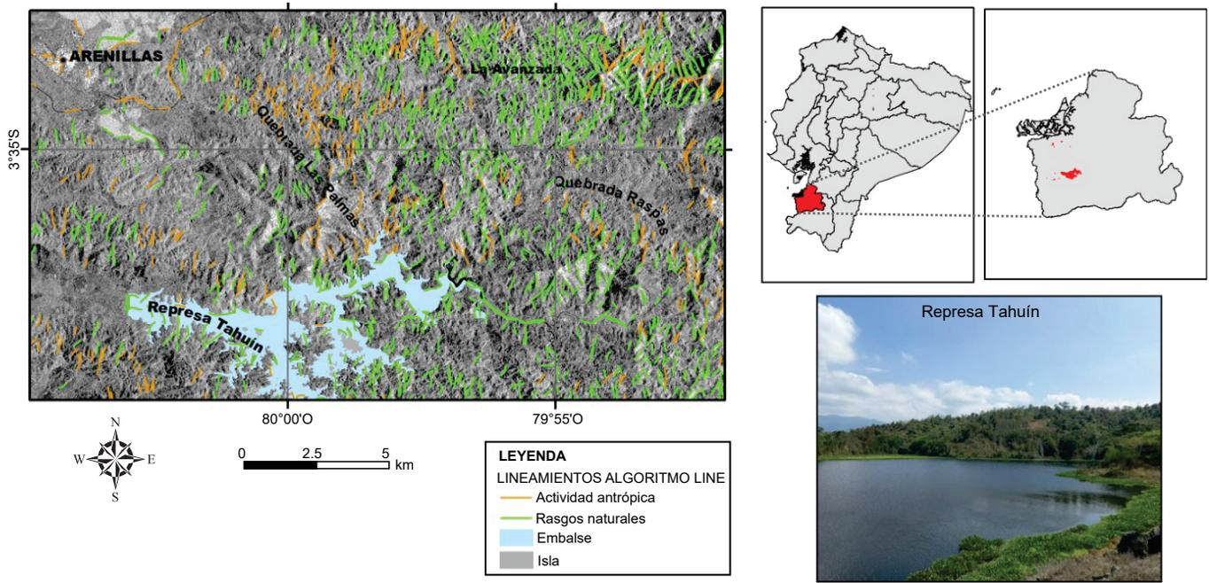
Figura 8. Líneas extraídas por el algoritmo LINE en la Represa Tahuín.
