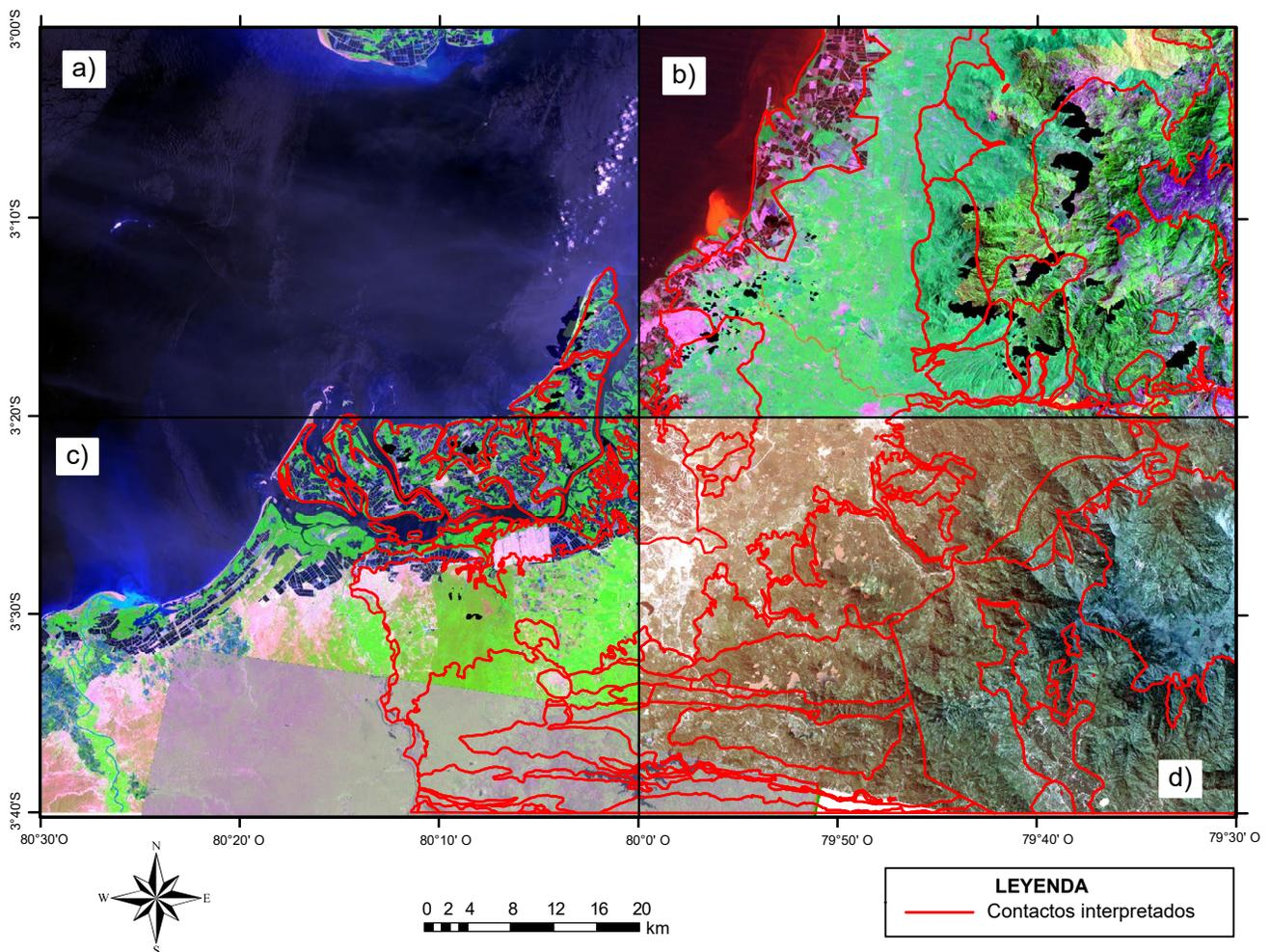
Figura 9. Contactos geológicos superpuestos en mosaicos de composiciones falso color RGB. a) imagen ASTER, combinación de bandas 742; b) imagen ASTER, combinación de bandas 247; c) imagen ASTER, combinación de bandas 742 y 435; d) Imagen Landsat, combinación de bandas 482.
