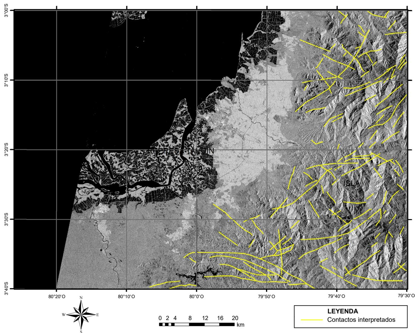
Figura 10. Estructuras geológicas superpuestas en la imagen de radar de alta resolución TerraSAR X.
